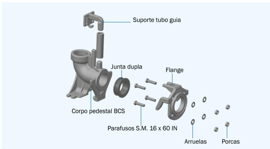
Figura 5 - Componentes do pedestal roscado.
